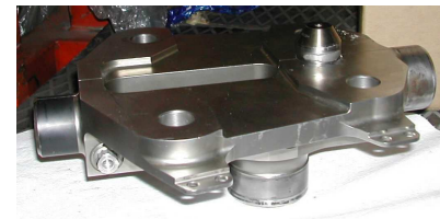
Axe de liaison réacteur – aile A340
