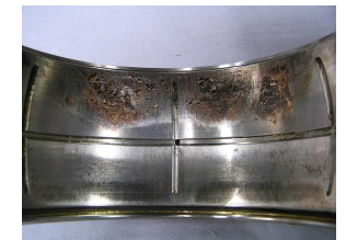
Rotules de mât réacteur fretting usure
